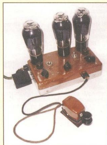
Obr. 21. Vysílač sovětské radiostanice NABLA, elektronky 6J7 (3x), 6L6 (3x) 5Z4
