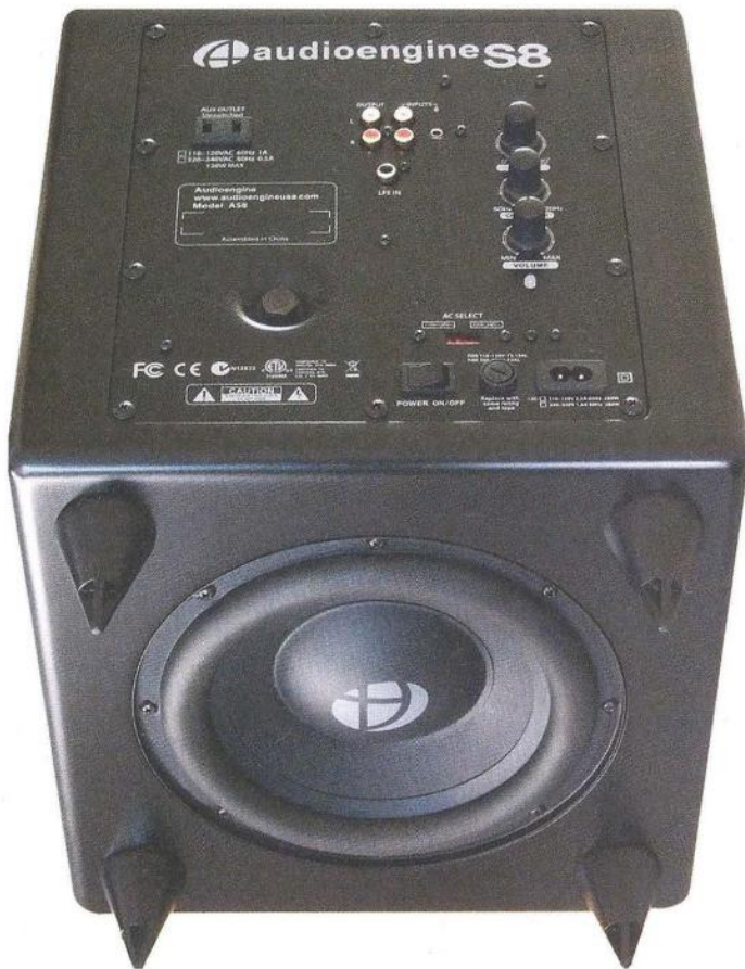
Obr. 13. Aktivní subwoofery mají někdy reproduktor umístěn dole - viz obrázek vlevo
