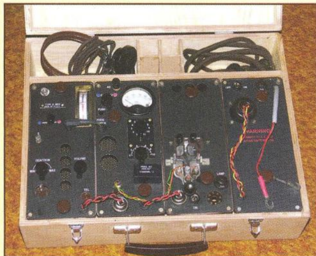
Obr. 16. Radiostanice A MK.II, elektronky 7Q7, 7H7 (2x), TT11 (replika)
