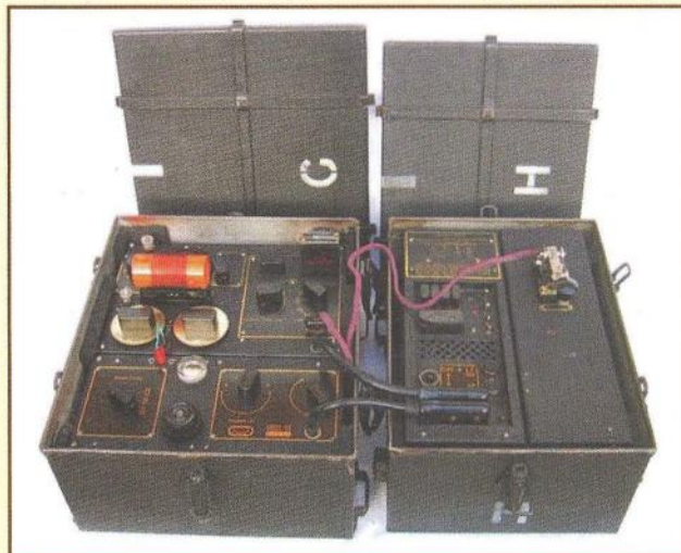
Obr. 17. Radiostanice B MK.II (3 MK.II), 7Q7 (2x), 7R7 (2x), EL32, 6L6
