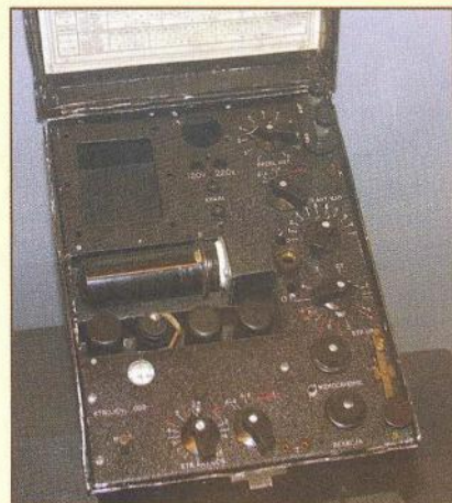
Obr. 15. Radiostanice AP5 z polské továrny, elektronky 6L6, 6K8, 6SJ7, 6SC7, 5Z4
