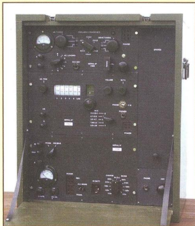
Obr. 20. Radiostanice MK119, elektronky EF91 (5x), EF92 (3x), EA50, 2E26 (replika, vpravo nahoře)
