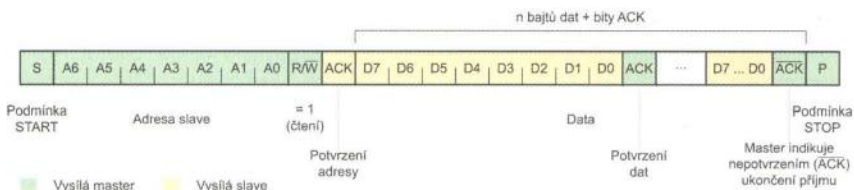
Obr. 78. Formát přenosu po sběrnici I 2 C v případě čtení dat z obvodu slavy při použití 7bitové adresy
